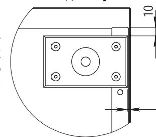
Опоры закрепите саморезами 4x16 (по 4 на каждую опору), используя разметку на нижней стороне. При отсутствии разметки, установите опоры по размерам, указанным на схеме.
